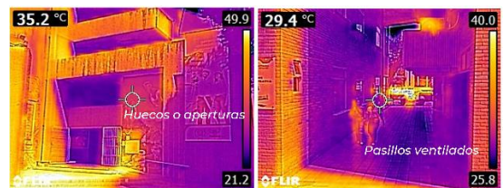
Fig. 6. Termografías de aperturas y pasillos ventilados en edificaciones. Fuente: elaboración propia
