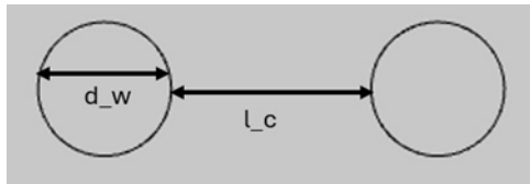
Fig. 3. Acercamiento al modelo de la bobina EMAT en COMSOL Multiphysics, con la separación entre conductores l_c y el diámetro del conductor d_w que definen la relación k_{lc} . Fuente: elaboración propia.
