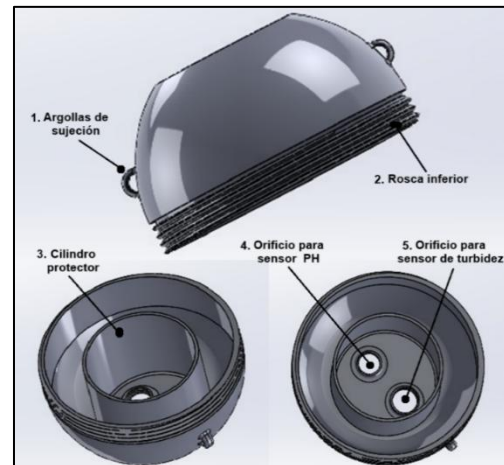
Fig. 5. Diseño de cubierta inferior (Nodo Sensor). Fuente: elaboración propia.
