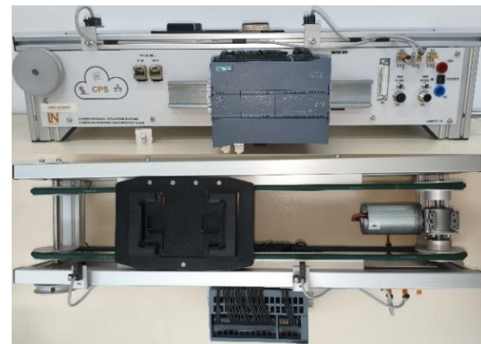
Fig. 3. Lucas-Nuelle Cyber physical conveyor system with PLC. Fuente: elaboración propia.
