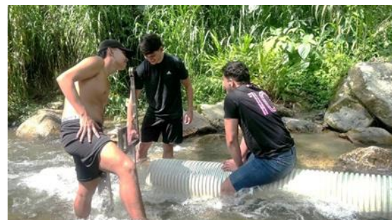
Fig. 4. Ensayos con canalización mediante tubería de PVC para la estabilización del flujo. Fuente: elaboración propia
