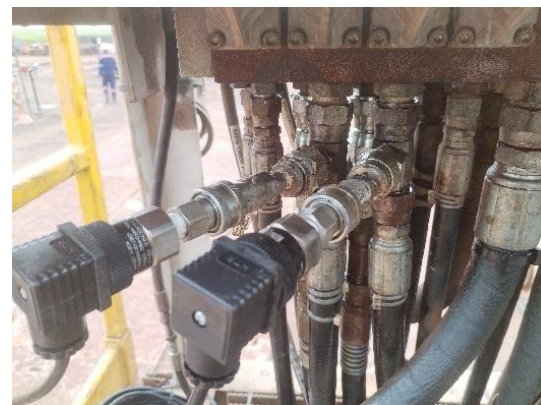
Fig. 5. Sensores de presión instalados en salida de las válvulas de la consola del "mast raising".
