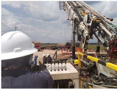
Fig. 1. Perspectiva del operador en los mandos de izaje del mástil – limitaciones de visibilidad en la nivelación transversal. Fuente: Autores.
