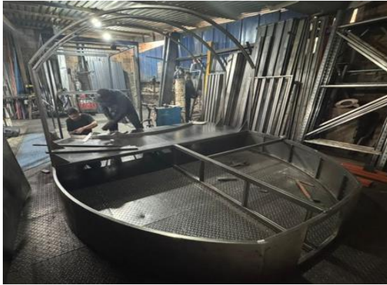
Fig. 10 Fabricación cabina C-130 Fuente: Elaboración propia
