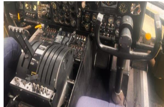
Fig. 14 Pedestal de potencias. Fuente: Elaboración propia
