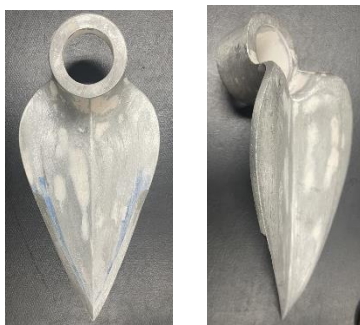
Fig. 9. Prototipo en fundición de aluminio, con molde en impresión 3D, (autores)
