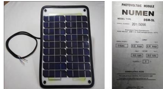
Figura 3. Panel solar NUMEN calibrado para medir irradiancia solar.
