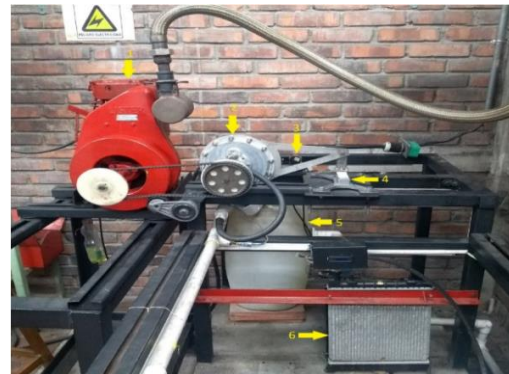
Fig. 5. Banco de pruebas para motores de combustión interna. Fuente: Autores
