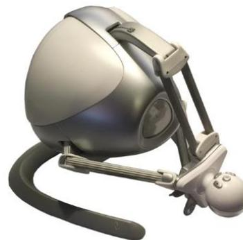
*Fig. 1. Dispositivo Háptico Novint Falcón*
