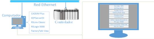
Fig. 2. Estructura del Entorno HIL seleccionado
