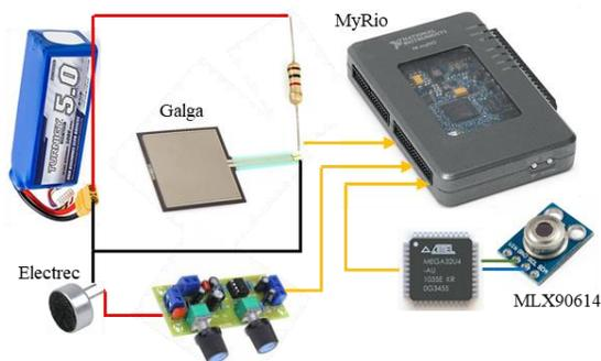
Fig 1: Sensores y circuito de acondicionamiento de señales para su posterior transmisión con la tarjeta MyRio.
