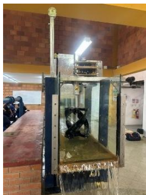
Fig. 5. Ensayos de laboratorio en canal hidráulico. Fuente: elaboración propia
