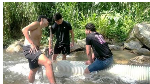
Fig. 4. Ensayos con canalización mediante tubería de PVC para la estabilización del flujo. Fuente: elaboración propia
