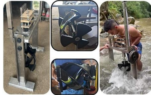
Fig. 3. Modulo fabricado, Rotor impreso en 3D y pruebas con flujo libre (sin canalización) Fuente: elaboración propia
