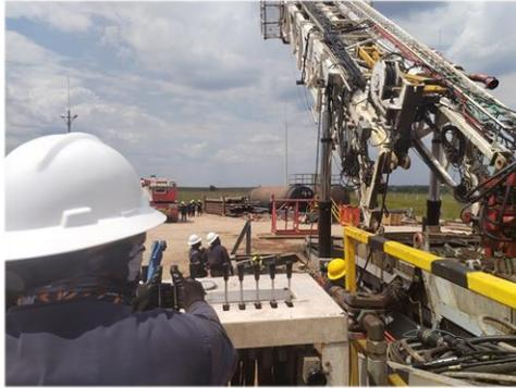
**Fig. 1.** Perspectiva del operador en los mandos de izaje del mástil – limitaciones de visibilidad en la nivelación transversal.
