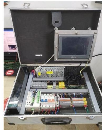
**Fig. 4.** Sistema de monitoreo de izaje de mástil.
