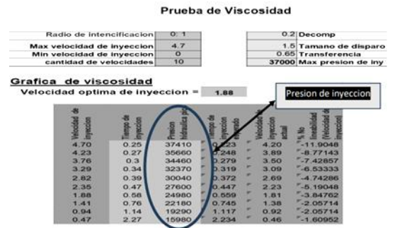
Fig. 2. Presión de inyección dentro de la prueba de curva de viscosidad. Fuente: elaboración propia
