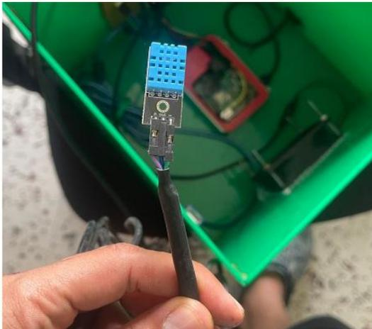
**Fig. 8.** Sensor DHT11
