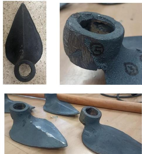
*Fig. 10. Fundición final en hierro fundido ASTM A536, (autores)*
