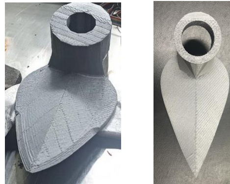
Fig. 4. Prototipos iniciales mediante impresión 3D, (autores).
