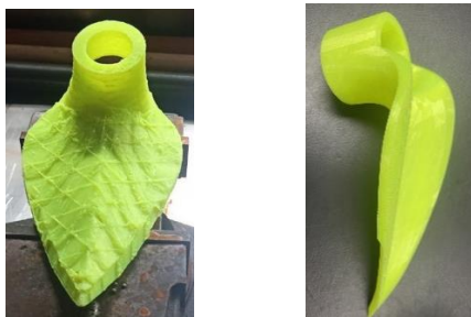
Fig. 6. Prototipo final mediante impresión 3D, (autores)
