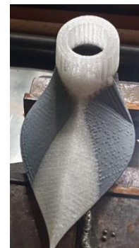
Fig. 5. prototipo mediante impresión 3D con correcciones en las medidas del ojal, (autores)
