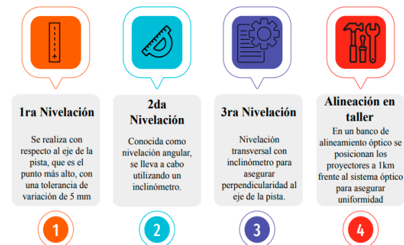
Fig. 2. Nivelaciones específicas Fuente: Barbosa, S. I. P.A.P.I. Precision Approach Path Indicator. Eletromundo
