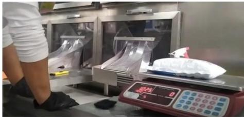
**Fig. 21.** Medición de peso de bolsa de leche recién envasada
