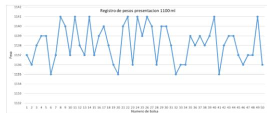
**Fig. 24.** Peso presentación 1100ml, cabezal 3 Fuente: elaboración propia.
