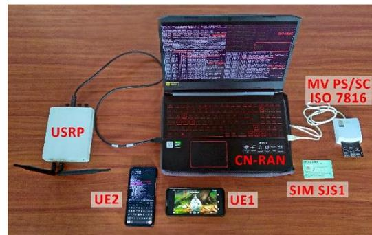
**Fig. 8.** Montaje real del CN y la RAN.
