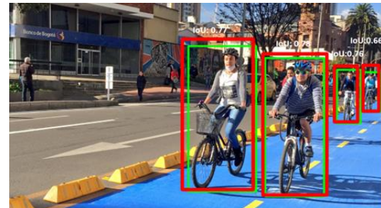
Fig. 4. Obtención del índice de superposición (IoU) para una imagen del grupo de imágenes de evaluación. El cuadro verde indica la región del ground truth, el cuadro rojo indica la región de detección
