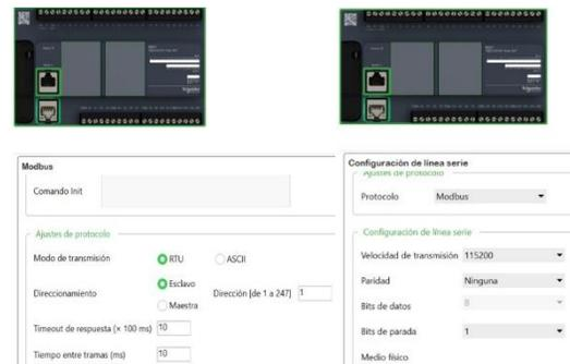
**Fig. 2.** Configuración serial y Modbus del PLC M221.
