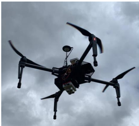
Fig. 2. Dron con una cámara multispectral Fuente: propia del autor.
