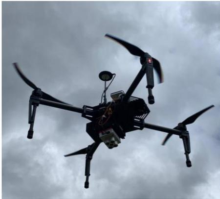
Fig. 2. Dron con una cámara multiespectral
