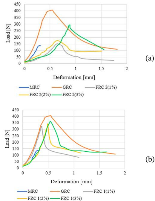
Fig. 2. (a) Curvas de carga vs. deformación de la muestra FRC-1 (fibras de fique). (b) Curvas de carga frente a deformación de la muestra FRC-2 (fibras de guadua). Comparado con curvas de MRC (sin fibras) y GRC (fibras de vidrio AR).
