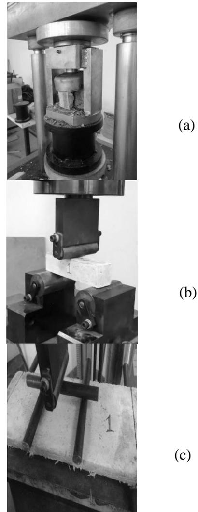
Figura 1. (a) Ensayo de compresión en cubos de 4x4x4cm. (b) Prueba de flexión en espacios en blanco de 4x4x16 cm. (c) Ensayo de flexión en placas de 2x15x40cm.
