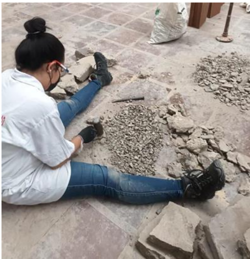
Fig. 2. Trituración Manual de RCD. Fuente: elaboración propia.
