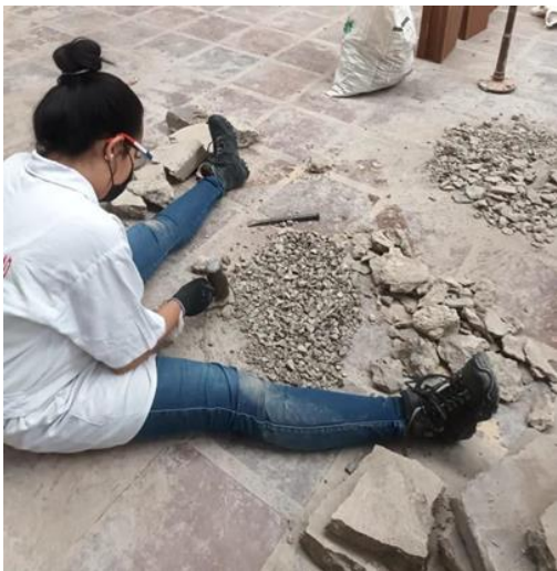
Fig. 2. Trituración Manual de RCD. Fuente: elaboración propia.
