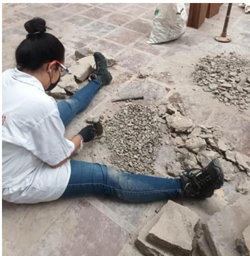
Figura. 2. Trituración Manual de RCD. Fuente: elaboración propia.
