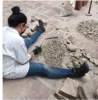
Fig. 2. Trituración Manual de RCD. Fuente: elaboración propia.
