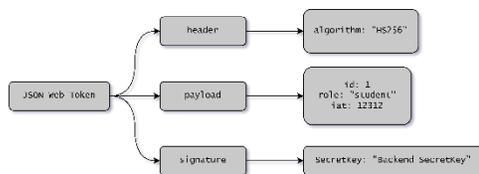
Fig.5 Estructura de la firma JWT - Fuente: autor
