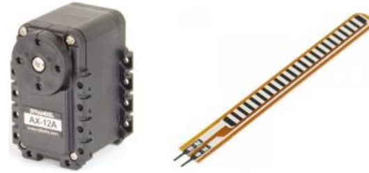
Figura 4. Servomotor y flexo-sensor empleados
