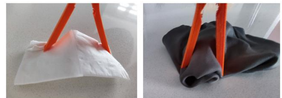
Fig. 10. Pruebas de agarre.
