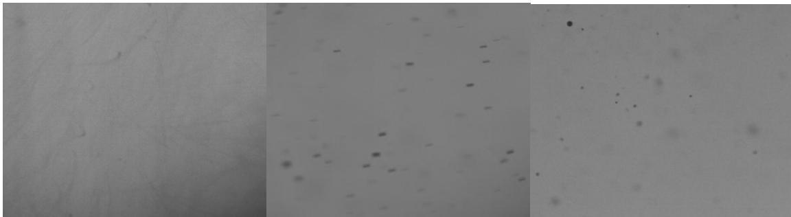
Fig. 2. Comparación de imágenes de sombras de gotas obtenidas de la misma fuente con diferentes tiempos de obturación: 1,6 ms (izquierda) 0,16 ms (centro) y 0,016 ms (derecha)
