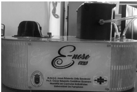
Figura 6 Nariz Electrónica (Universidad de Pamplona) (Gualdrón et al. , 2014).
