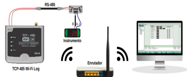
Fig. 6. Esquema de conexión controlador-convertidor-computador
