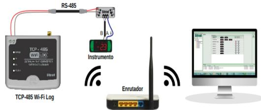
Fig. 6. Esquema de conexión controlador-convertidor- computador
