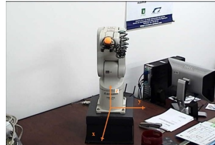
Fig. 5. Brazo Robótico RV2AJ de prueba (Ejes coordenados de la base del robot)
