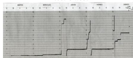
Fig. 13. Pluviograma obtenido con Pluviógrafo tipo Hellman de sifón Automático.
