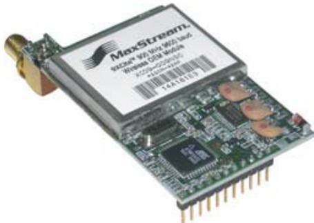
Fig. 3. 9XCite OEM RF module.
