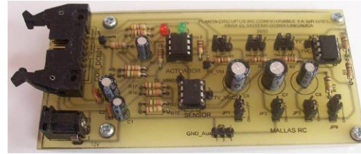
Fig. 6. Imagen real de la planta de circuitos RC.
