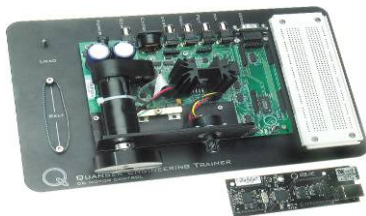
Fig. 2. QET Control de un Motor DC.
