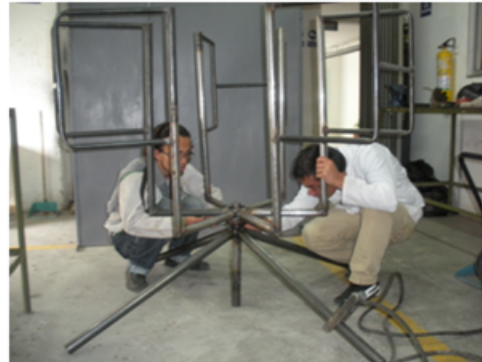
Fig. 8. Proceso de fabricación del juego tiovivo.
