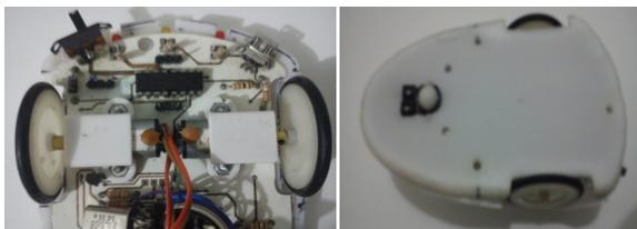
Fig. 3. Sistema de tracción del robot.
