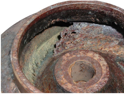
Fig. 1. Daño de impulsor de una bomba centrífuga producido por cavitación.
