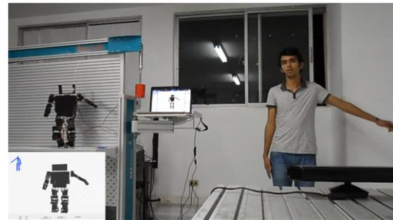
Fig. 16. Teleoperación del Robot humanoide UPABOT con kinect
