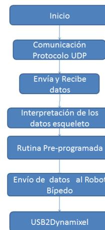
Fig. 15. Algoritmo del Robot Bípodo.
