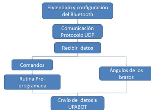
Fig. 14. Diagrama del algoritmo del Robot UPABOT
