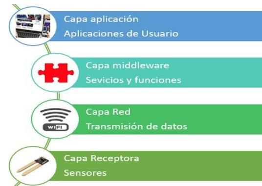
Fig. 1. Capas de abajo-arriba arquitectura IoT seleccionada
