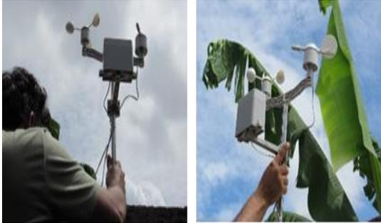
Fig. 5. Estación meteorológica instalada en la finca para monitoreo de variables físicas por medio IoT
