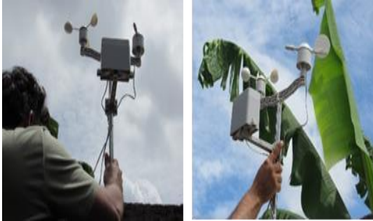
Fig. 5. Estación meteorológica instalada en la finca para monitoreo de variables físicas por medio IoT
