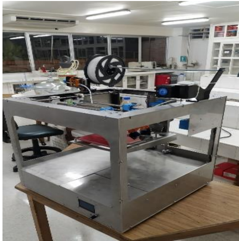
Fig. 1. Diseño de la estructura metálica de la impresora 3D
