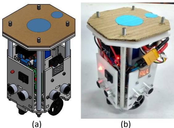
*Fig. 2. Robot móvil de transmisión diferencial. (a) Modelo en CAD (b) Robot real*
